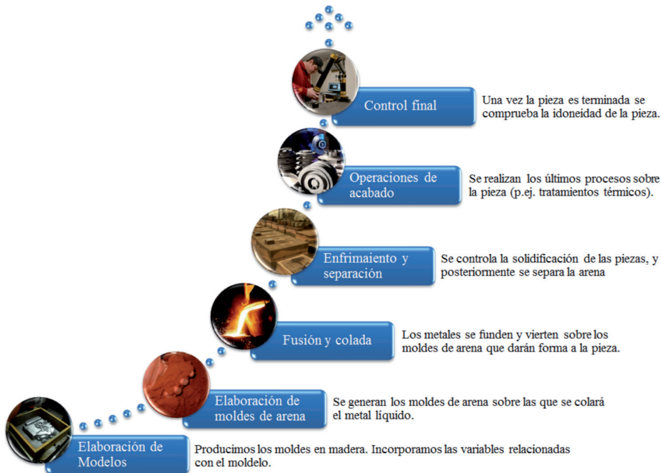
Fig. 2: Representación del proceso productivo de la fundición
